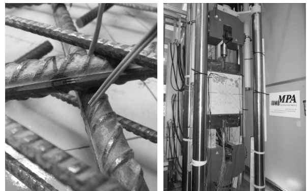
BILD 3 DMS-Applikation und Prüfung Kleinversuch
