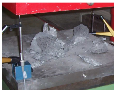
BILD 1 Probekörper aus UHPC 145 nach dem Versuch
