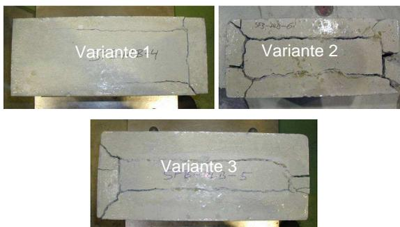
BILD 4 Bruchbild Versuchskörper mit unterschiedlicher Lastplattenbreite
