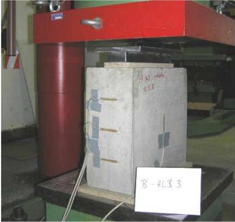
BILD 3 Versuchskörper mit Dehnmessstreifen
