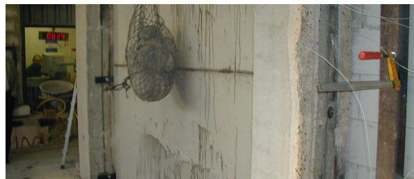
BILD 4 Stoßbeanspruchung einer Brandwand nach erfolgter Brandeinwirkung
