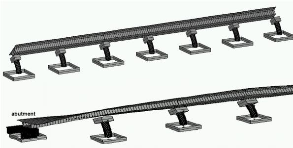
BILD 3 Erste Eigenform einer typischen „regulären“ (oben) und „irregulären“ (unten) Brücke
