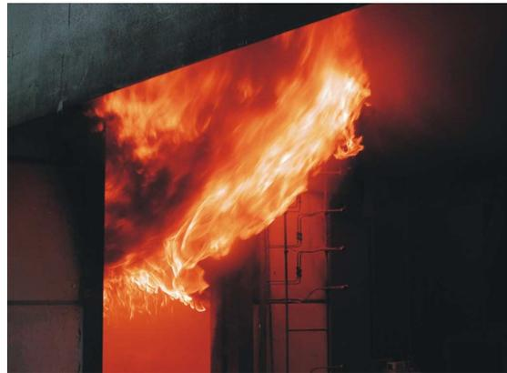
Bild 2 „flash over“ im Brandraum nach ISO 9705
