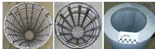
BILD 3 Bewehrungskörbe und betonierter Versuchskörper
