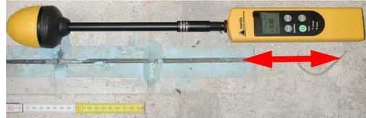
Abb. 6: Feldstärkemeter als Messgerät zur externen Feldstärkemessung auf einem Betonversuchskörper mit Styropor-Hohlkörper bei einseitiger Einkopplung des monofrequenten HF-Signales in ein Spannglied
