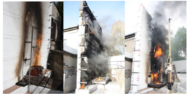
Bild 3 Brandgeschehen nach ungefähr 30 Minuten: V1 (links), V2 (Mitte), V3 (rechts)
