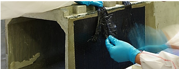
Bild 5: Verstärkung des Steges von PB2 nach Querkraftversagen von PB1
