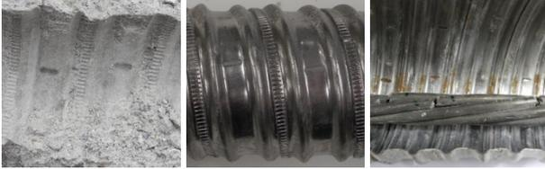
Bild 3: Reibspuren am Beton (links), am Hüllrohr (Mitte) und daraus resultierte Drahtbrüche (rechts)
