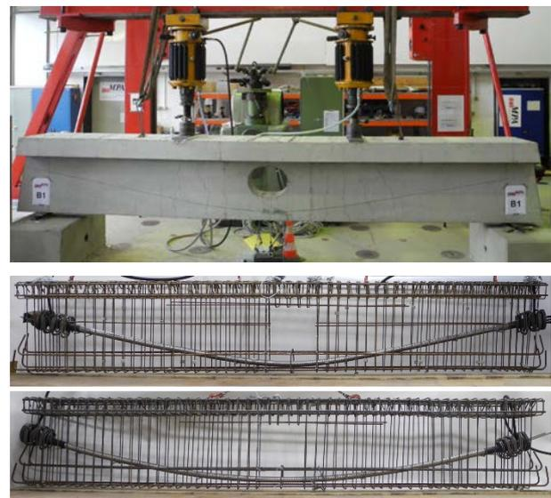
Bild 2: Versuchsstand (oben), Bewehrungskorb von B1 bis B3 (Mitte) und B4 (unten)
