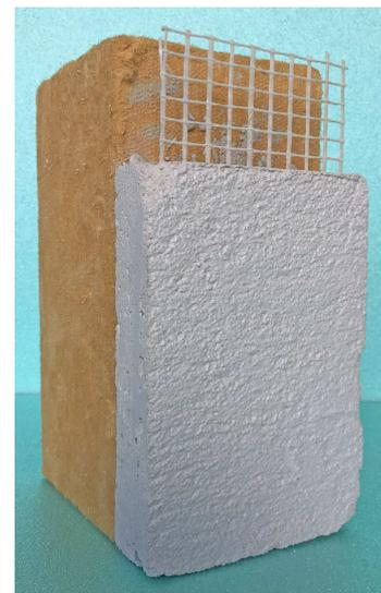
Bild 1 Aufbau eines WDVS mit Holzfaserdämmplatten
