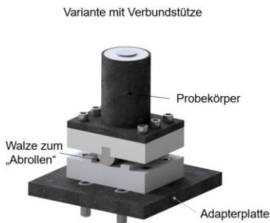
Bild 2: Schematische Darstellung des Auflager Prüfstandes
