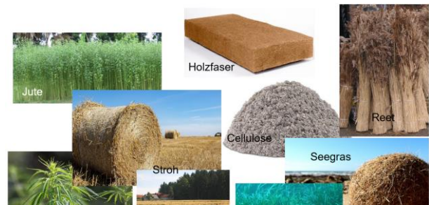
Abbildung 1 Eingesetzte Materialien für Dämmstoffe aus nachwachsenden Rohstoffen
